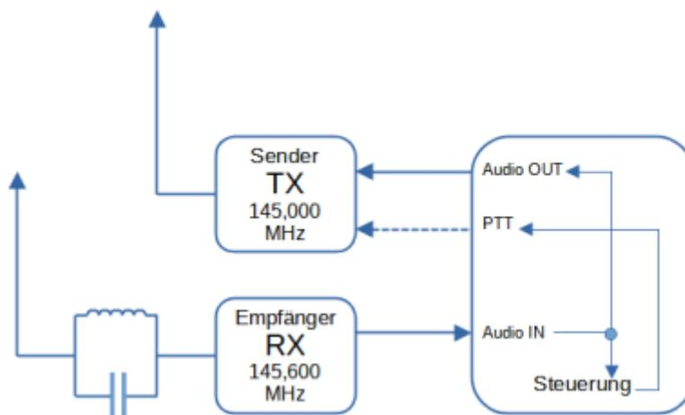
Etwas komplizierter wird es, wenn man erreichen möchte, dass die Sprache, welche der Repeater empfängt, gleichzeitig ausgesendet wird - also Funkverbindungen in Echtzeit ohne lästiges Warten durchgeführt werden können. Hier bedarf es etwas mehr Technik: Zwei getrennte Antennen, zwei getrennte Funkgeräte, eine **Repeater-Steuerung** (muss kein Computer sein, einfache Elektronik reicht) sowie ein Filter namens **Topfkreis**.
