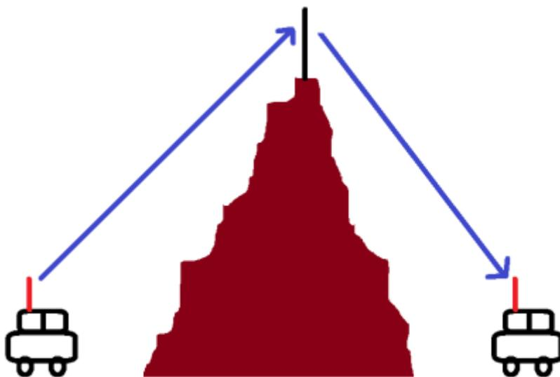
Ein Repeater verfolgt in der Regel den Zweck, die Reichweite einer Funkstation massiv zu erhöhen. Auch ermöglicht ein Repeater es, aus einem Tal ohne Funkempfang tatsächlich auf UKW Funkkontakte **über den Berg hinüber** zu führen. Daher kommen Repeater auch vorwiegend im UKW-Bereich zum Einsatz, können aber auch im 10-Meter Amateurfunkband ebenso wie im 11-Meter-CB-Funkband betrieben werden.
