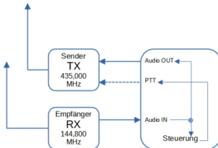
Des Funktionsprinzip bleibt exakt das Gleiche, wie bei einem Semi-Duplex-Repeater - mit EINEM Unterschied: Sende- und Empfangsfrequenz liegen in unterschiedlichen Frequenzbändern (wie im Bild beispielsweise gewählt). Mit einem Funkgerät, welches ebenfalls auf den beiden Frequenzbändern **gleichzeitig senden und empfangen** kann, kann man sich nun selbst sprechen hören - und damit eine Funkverbindung wie bei einem Telefonat führen, in dem man seinen Funkpartner **ins Wort** fallen kann.
