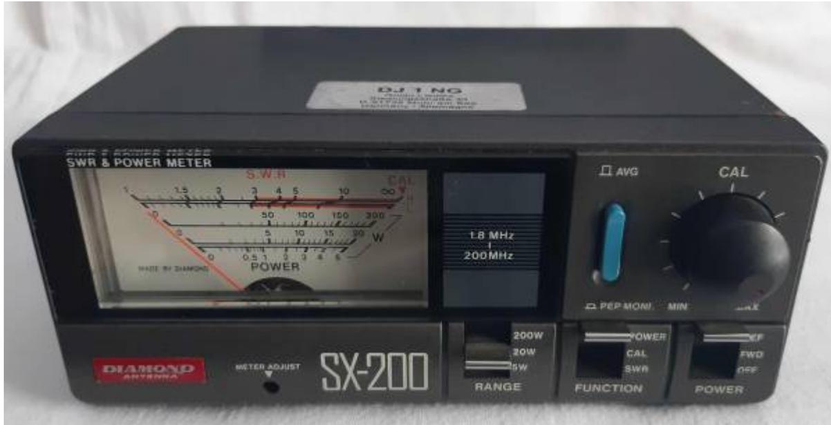
Mit einem solchen Messgerät kann man entweder die Sendeleistung im einzelnen messen (FWD = Vorwärts-Leistung / REF = Rücklauf-Leistung) oder sich dieses konkret als SWR-Wert anzeigen lassen. Diese Messgeräte sollten zur Grundausstattung eines jeden Funkamateurs oder Jedermannfunker gehören. Zur Nutzung der SWR-messfunktion muss das Gerät erst abgeglichen werden (CAL = Calibration). Bei jedem Kanal-/Frequenzwechsel ist ein neuer Abgleich notwendig.
