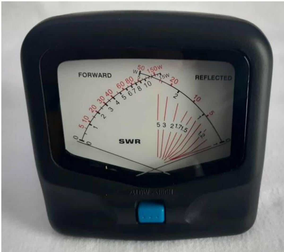
Dieses Messinstrument zeigt beide Werte gleichzeitig an: Sendeleistung und SWR-Wert. Es muss nicht abgeglichen werden sondern allenfalls in der der Sendeleistung (und damit in der Skala) umgeschaltet werden. Da man dieses Gerät nicht ständig nachstellen muss, bietet es einen guten Überblick zum Abstimmen einer Antenne, weil einfach so „über die Kanäle“ gedreht werden kann und man dabei gut das Absinken oder Ansteigen der zeiger beobachten kann.
