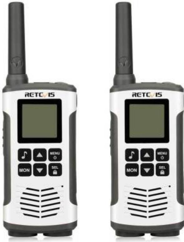
Die Geräte werden paarweise zu einem extrem günstigen Preis verkauft, sind sehr robust und können mit AAA-Akkus/-Batterien betrieben werden. Leider ist die Antenne recht kurz (Nachteil), dafür sind die Geräte aber Hosentaschen-Klein und können zudem direkt an einem beliebigen USB-Anschluss geladen werden.
