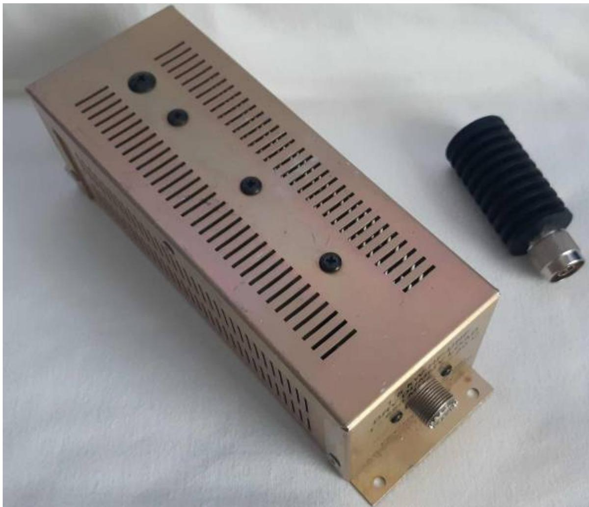
Man kann diese Widerstände in allen möglichen Bauformen kaufen oder selbst bauen. Im professionellen Funkbereich spricht man meist von einem „Abschluß-Widerstand“ und nutzt kleiner Maximalleistungen (siehe rechts im Bild). Funkamateure hingegen nutzen gerade auf Kurzwelle bis zu 750 Watt **Sender-Ausgangsleistung (PEP)** und benötigen daher recht belastungsfähige Dummy Loads.
