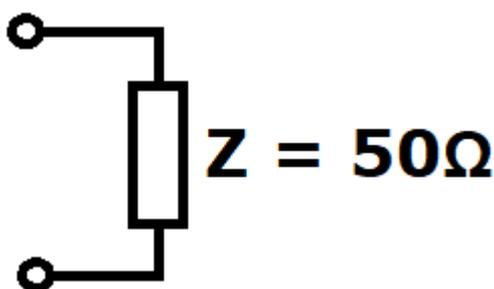
Es handelt sich um einen normalen Ohm'schen Widerstand mit 50 Ω (Wechselstrom- und Gleichstromwiderstand).
