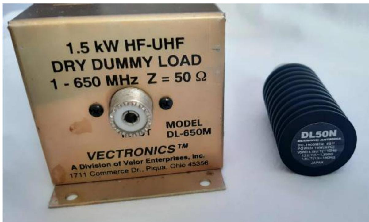
Da es keine Widerstände gibt, welche beispielsweise seine elektrische Leistung von 1000 Watt aushalten, werden diese in der Regel gekühlt. Hier kommt entweder eine passive Kühlung (Konvention, Luftdurchsatz, Kühlrippen) oder eine aktive Kühlung (Kaltluftgebläse) zum Einsatz. In Amateurfunkkreisen wird gerne ein Metalleimer mit Maschinenöl gefüllt und die künstliche Antenne in diesem versenkt.
