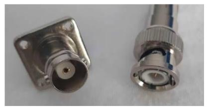
Die Stecker selbst sind etwas knifflig zum löten. Dafür ist das Koaxialkabel gegen herausrutschen durch eine Mutter gesichert. Der Stecker wird mit einem Bajonett-Verschluss an der Buchse gegen herausreissen gesichert. Daher kommt wohl die Beliebtheit im Labor-Bereich, da die Steckverbindung extrem schnell hergestellt wird ohne lästiges "Verschrauben".
